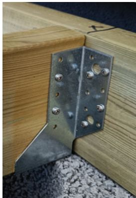
Palkkikenkä Kiinnitys 8+4 kpl 4x40 ankkurinaulaa
