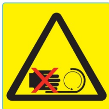
Tarra varoittaa puristumisvaarasta kuljettimen vetotelan ja kuljetinhihnan välissä (2kpl).
