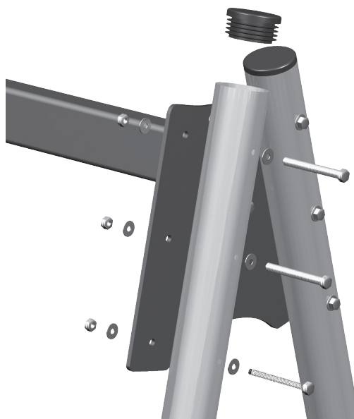
Kuva 4, teräsjalkojen kiinnitys. Yksi jalka: 3 kpl M12x120-ruuveja, 3 kpl M12 Nyloc -muttereita, aluslevyt molemmin puolin. Taaempi jalka valmiiksi kiinnitetty, suojatulppa (Ø 90 mm) paikallaan.
