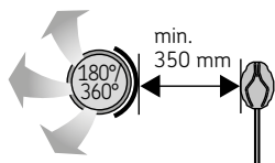
Bild 9. Minimiiavstånd mellan tilluftsventil och temperaturgivare.
