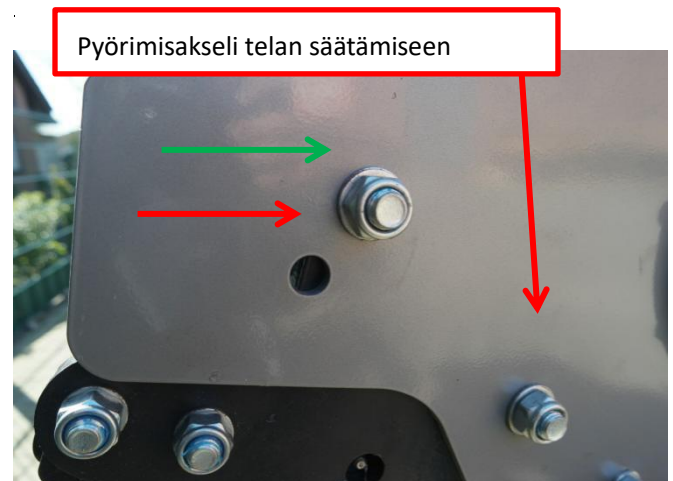
Kuva 139 Telan säätäminen, oikealta puolelta katsottuna
