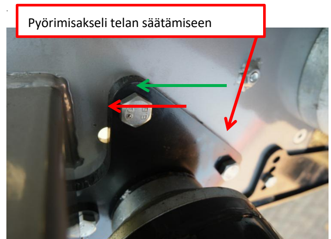
Kuva 140 Telan säätö, vasen, kuva sisäpuolelta
