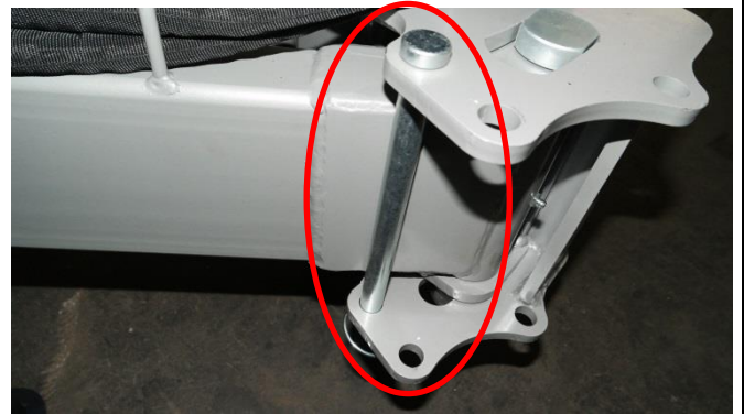
Kuva 147 Tukivarren pultin lukitusasento
